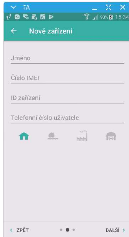
Obr. 36. Aplikace GX Control (systém Android): manuální konfigurace parametrů nového modulu.
